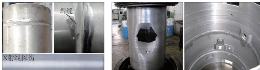
(a) 搅拌摩擦焊,直径535mm筒体
